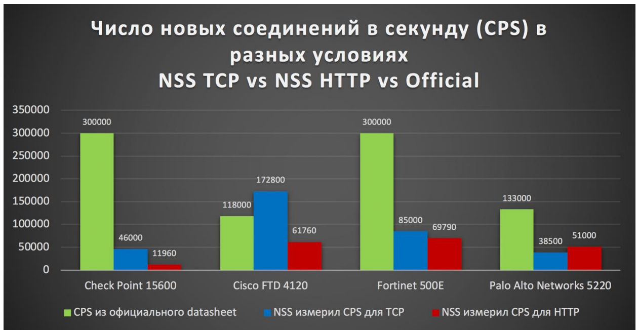
Рис. 3. Пример неверного сравнения: максимальные значения CPS из теста NSS Labs в режиме анализа HTTP (выделено красным) и без анализа (выделено синим) и CPS из официальных datasheet (выделено зеленым) (1)
